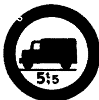
18e) – Trânsito proibido a veículos de carga de peso total superior a... toneladas 禁止總重量超過.....公噸之載重車輛通行
