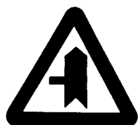
2d) – Entroncamento com via sem prioridade T型交叉有權先行
