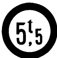
18f) – Trânsito proibido a veículos de peso total superior a... toneladas 禁止總重量超過.....公噸之車輛通行
